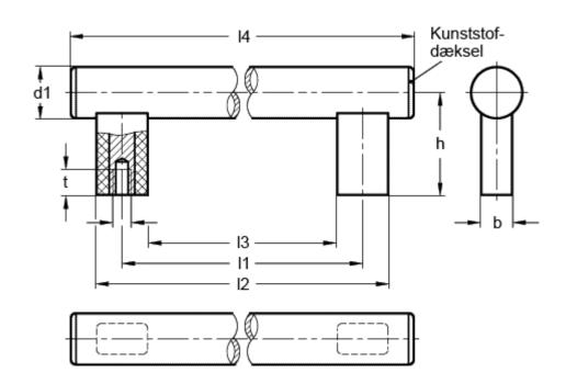
b = 18 t min = 15 d1 = 30 d2 = M8 h = 60 l1 = 300 l2 = 330 l3 = 270 l4 = 365
